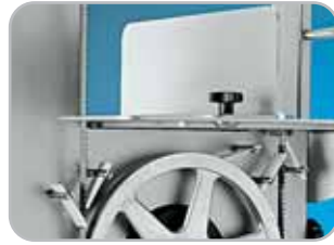
Raschiatori lama in materiale plastico alimentare ad innesto rapido. Flangia in materiale plastico alimentare nero a tenuta stagna per protezione motore Alimentary plastic blade scraper in quick to insert. Watertight black plastic flange to protect the motor
